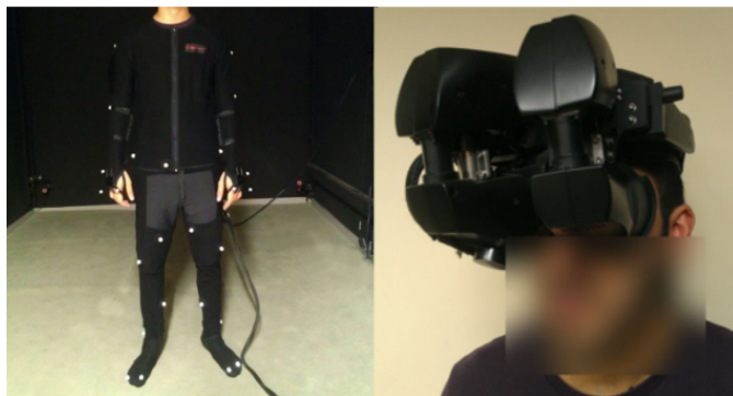
Figura 1. Traje con sensores de movimiento del cuerpo (izquierda) y casco de realidad virtual (derecha).
